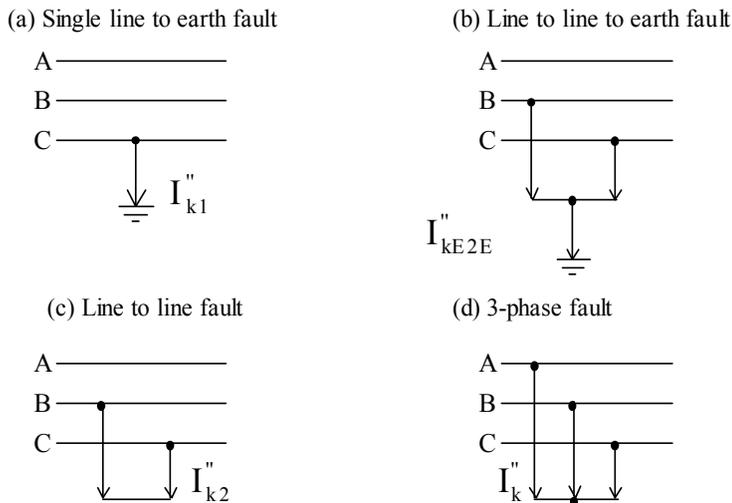
Figure 7.1. Equivalent circuits of symmetrical (d) and unsymmetrical faults (a-c)
