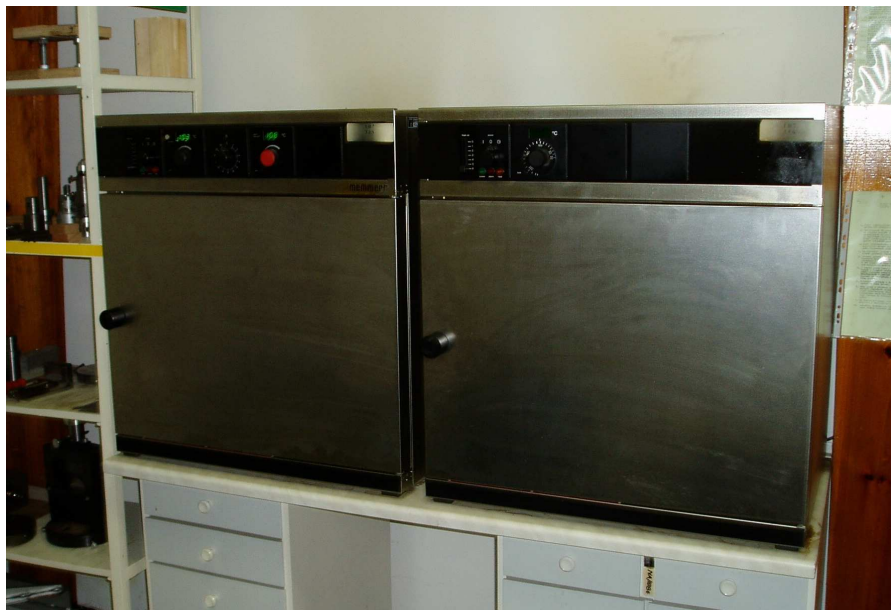
Fot. 5. Komora suszarnicza i klimatyczna – wykorzystywane w procesie klimatyzowania próbek z drewna przed badaniami wytrzymałościowymi, przy kontrolowanej temperaturze i wilgotności (fot. Łapka)
