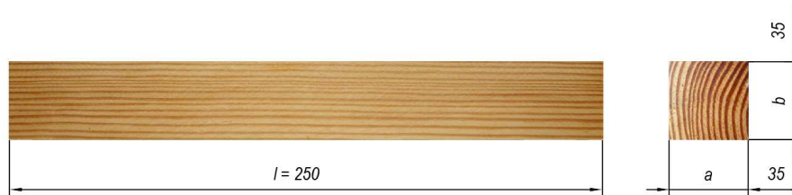
Rys. 43. Wymiary próbki drewna sosny przeznaczonej do badania wytrzymałości na ściskanie wzdłuż włókien, gdzie: l – długość próbki, a – przekrój w kierunku promieniowym, b – przekrój w kierunku stycznym
