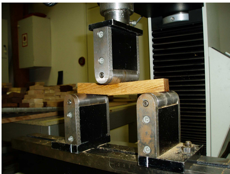
Fot. 10. Przykład zniszczenia próbki pod wpływem działania maksymalnego obciążenia przy oznaczaniu wytrzymałości na zginanie statyczne metodą trzypunktową (fot. Łapka)
