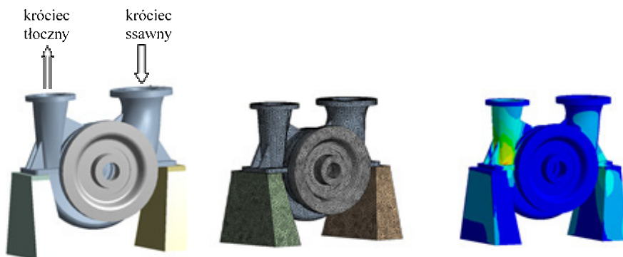
Rys. 5. Model obliczeniowy pompy procesowej dla metody elementów skończonych
