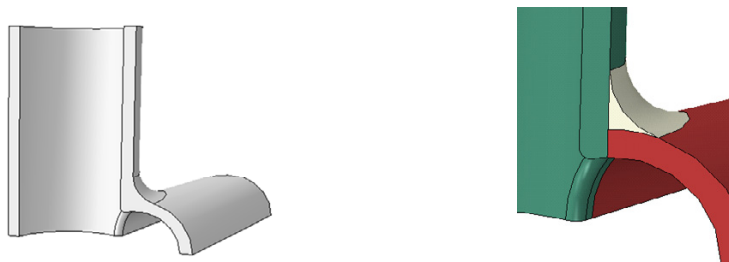
Rys. 5. Model połączenie krzyżowego w systemie CAD – podział strefowy połączenia: rura o średnicy Ø273 mm (zielony) oraz Ø219 mm (czerwony), uproszczony model spoiny (biały) [14]
