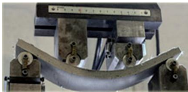
Rys.6. Zachowanie ECC podczas testu czteropunktowego zginania; [17]
