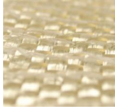
Rys. 3. Tkanina z kompozytu poliestrowo – szklanego [4]
