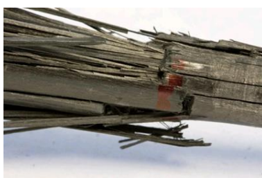
Rys. 2. Uszkodzenie cięgna pod wpływem działaniem siły poprzecznej wywieranej przez zakotwienie [2]
