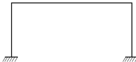
Rys. 6. Schemat statyczny mostu zintegrowanego
