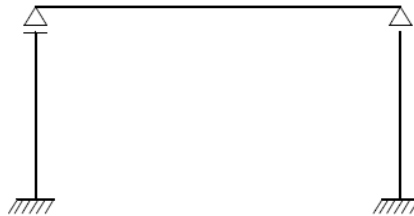
Rys. 3. Schemat statyczny mostu jednoprzęsłowego
