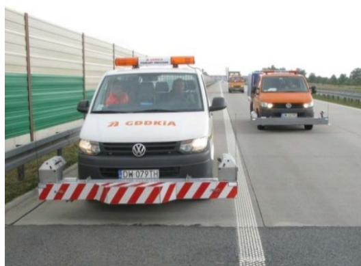
Rys. 1. Profilografy laserowe w trakcie badań porównawczych (przed rozpoczęciem pomiaru). W tle pojazd zabezpieczający
