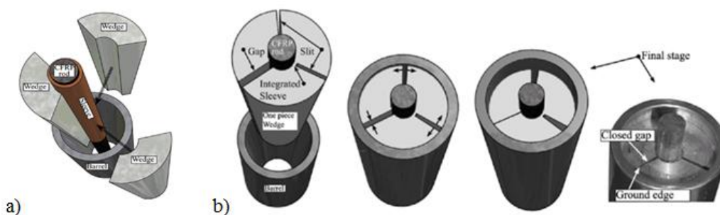
Rys. 4. Zakotwienie szczękowe do ciągów CFCC: a) typowe, b) zintegrowane jednoczęściowe [10]
