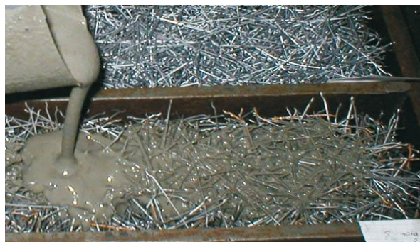
Rys. 4. Przygotowanie elementu w technologii SIFCOM; [14]
