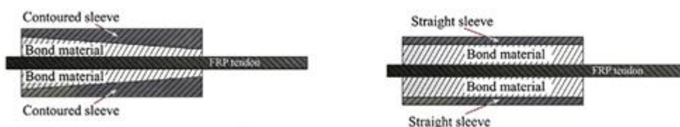
Rys. 3. Budowa zakotwień przyczepnościowych [10]
