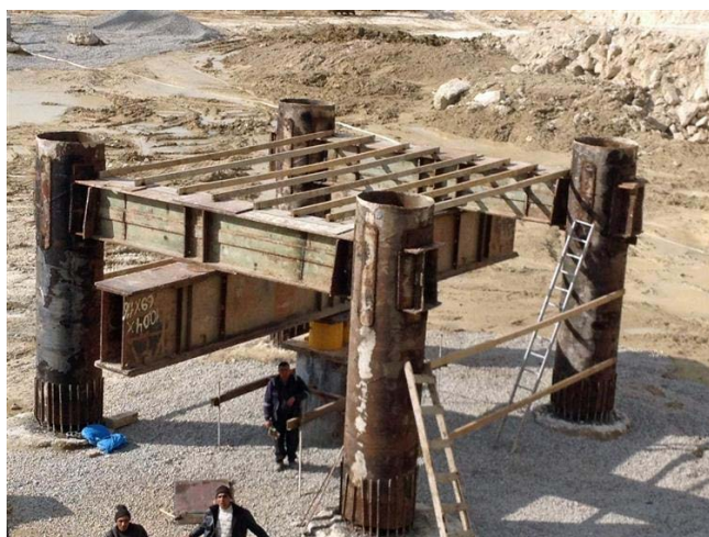
Rys. 1. Próbne obciążenia statyczne [1] i wyniki badań [2]
