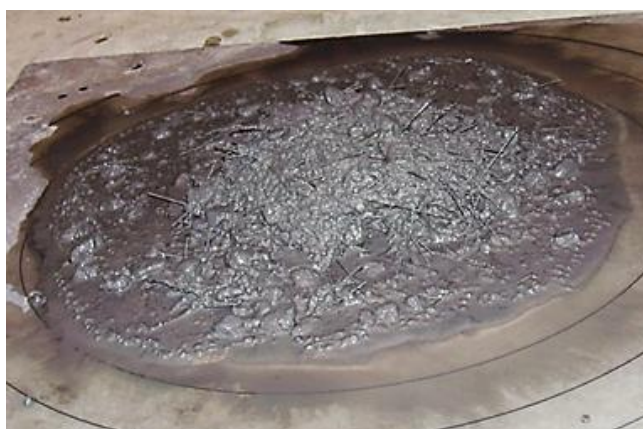
Rys. 3. Wygląd mieszanki betonowej z objętościową zawartością włókien 2% w teście rozpląwu.
