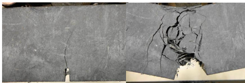
Rys. 2. Zachowanie się SRCC chwili po zarysowaniu (lewo); w chwili przenoszenia obciążenia rysującego przy znacznym odkształceniu, po fazie wzmocnienia (prawo); [5]
