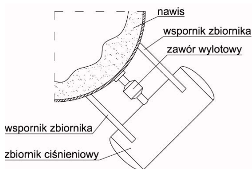
Rys. 4. Działo powietrzne zamocowane do płaszcza silosu
