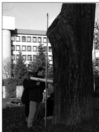
Fot. 2. Badanie rezystografem IML 400
