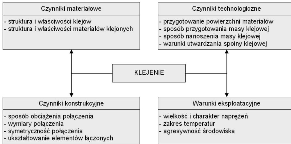
Rys. 8.5. Wpływ poszczególnych czynników na uzyskanie poprawnego połączenia klejowego [1,2]
