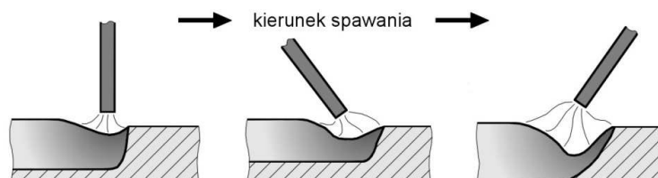
Rys. 2.6. Wpływ pochylenia elektrody na kształt spoiny [2,3]
