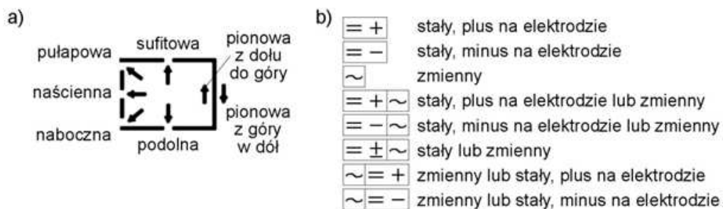
Rys. 2.4. Oznaczenia pozycji spawania (a) oraz rodzaju prądu i jego biegunowości (b) umieszczane na opakowaniach z elektrodami
