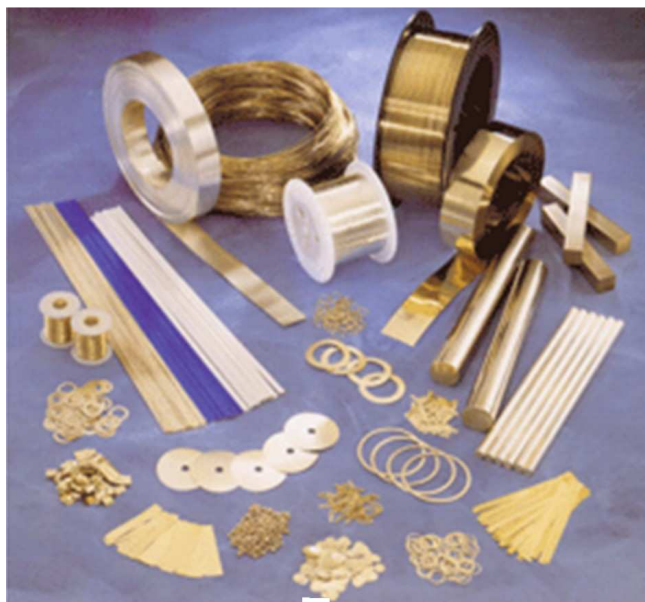
Rys. 7.8. Standardowe postacie lutów i przykładowe kształtki
