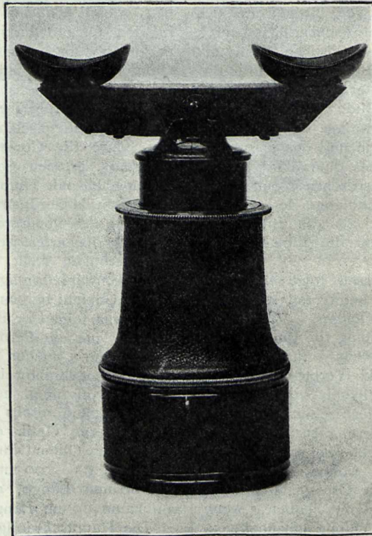
Prismenfernrohr mit Binocularstutzen und einem Objectiv (vor 1870).
