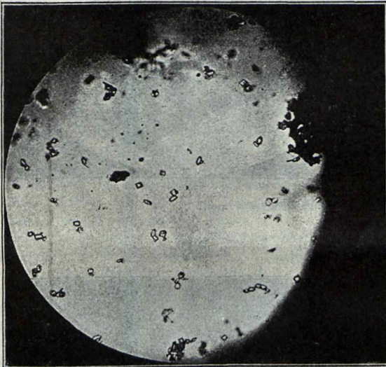
Diamantkryställchen (Oктаёдер) aus ungewalztem und ungehämmertem Stahl (300fache Vergrösserung).
