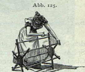
Abb. 125. Zerschneiden der Cellulosefäden in die erforderliche Länge.
