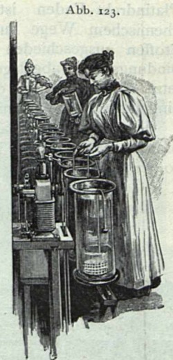
Abb. 123. Herstellung der Cellulosefäden.
