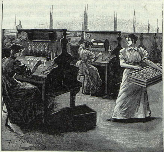
Luftentleerung der Glasballons und Abschmelzung der Stengel.
