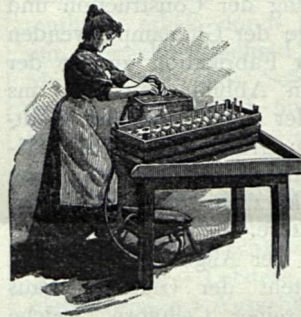
Prüfung der Glasballons unter Wasser auf Undichtigkeit.
