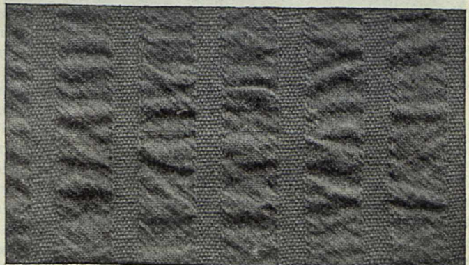
Abb. 453. Halbwoolles Gewebe nach der Mercerisation.
