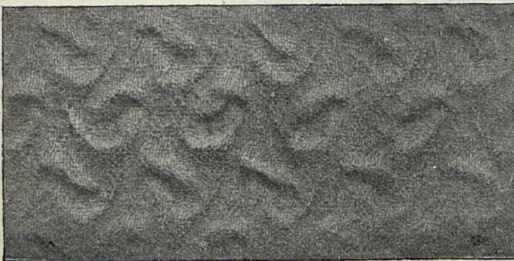
Mit Natronlauge bedrucktes Baumwollzeug.
