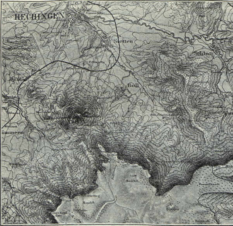
Höhencurven und Schraffur mit senkrechter Beleuchtung. Ausschnitt in \frac{2}{3} der natürlichen Grösse aus der Karte der Hohenzollerschen Lande 1:50000. (Das Original ist dreifarbig gedruckt, und zwar die Situation schwarz, die Berg- schraffur blauschwarz, die Höhencurven rothbraun.)
