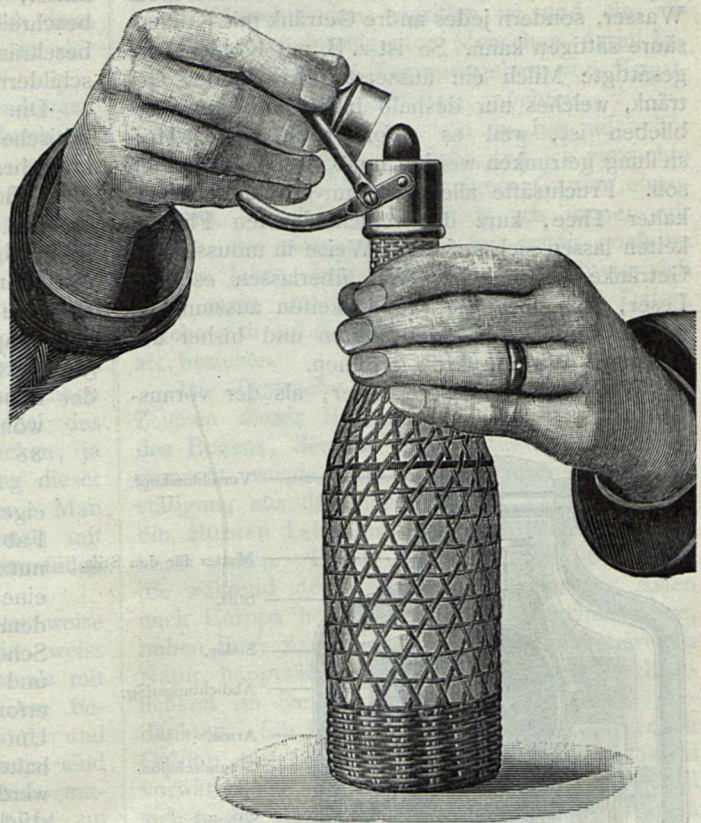
Sodorflasche mit geöffnetem Verschluss und eingesetztem Sodor, zum Gebrauch bereit.
