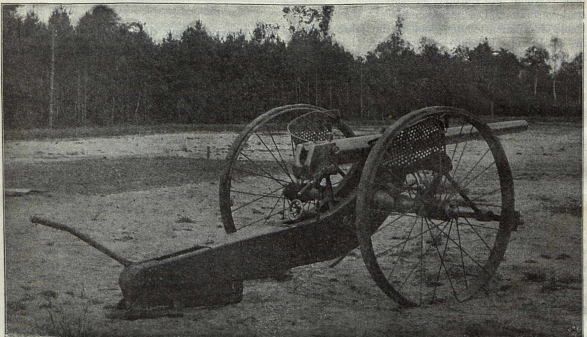
6,5 cm - Schnellfeuer - Kanone L/35 mit senkrechtem Keil-Verschluss in Feldlafette mit Flüssigkeits-Spornbremse, Rädern mit stählernem Felgenkranz und Drahtspeichen, Radreifen - Fahrbremse und Achssitzen.
