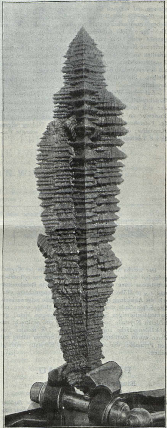
Stahlkrystall aus der Sammlung des Herrn Professor Tschernoff in St. Petersburg. (Natürliche Länge 39 cm.)
