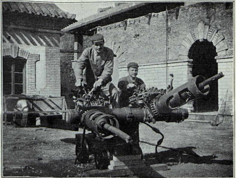
Zwei Brandtsche Bohrmaschinen auf einer Spannsäule.
