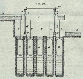
Skizze der Anordnung des Schiffshebewerks bei Henrichenburg.
