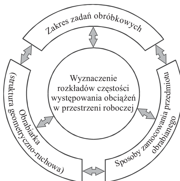
Rys. 5.5. Czynniki wpływające na rozkład częstości występowania obciążeń w przestrzeni roboczej obrabiarki
