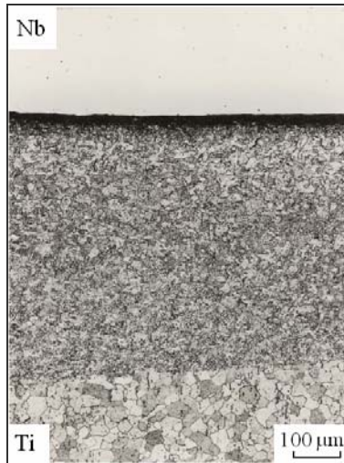
Rys. 4.73. Mikrostruktura zgrzewanego tarciowo złącza niob–tytan (według [8])
