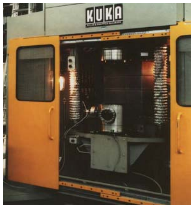
Rys. 4.78. Widok zgrzewarki tarciovej (układ pionowy) stosowanej w badaniach, z zamontowanym zbiornikiem na ciecz (a), widok stanowiska z próbkami zgrzanyimi tarciove w szczękach wrzeciona (b)
