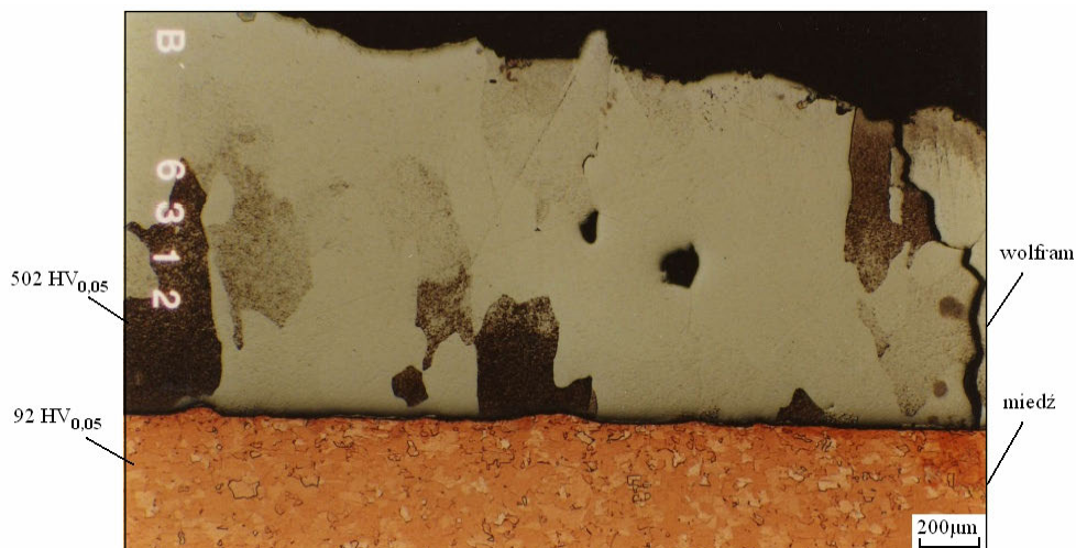
Rys. 4.23. Mikrostruktura połączenia miedź-wolfram (fragment złącza wolfram-miedź-stal austenityczna po próbie rozciągania) (według [8])
