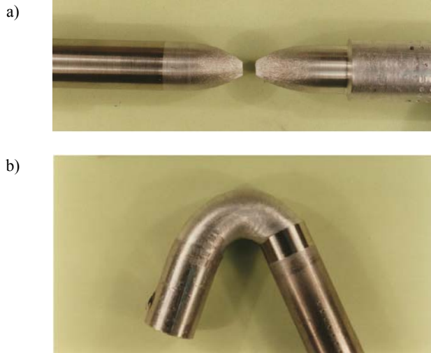
Rys. 4.27. Widok złączy zgrzewanych tarciowo aluminium 99,8–stal austenityczna X10CrNiT189 po statycznej próbie rozciągania (a) i po technologicznej próbie zginania (b)
