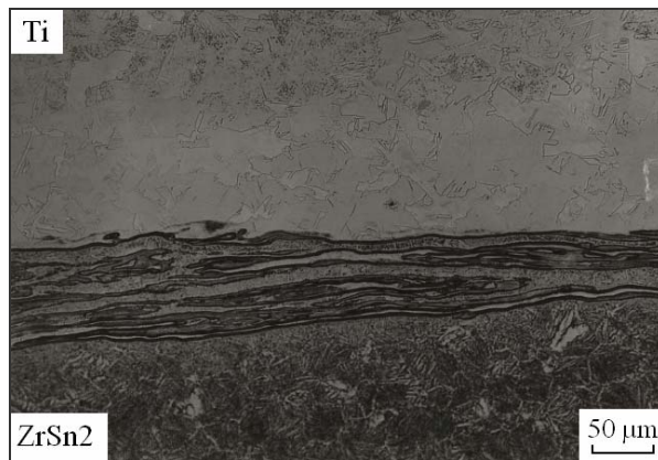
Rys. 4.75. Mikrostruktura zgrzewanego tarciove złącza tytan–zircałoy 2 (według [8])
