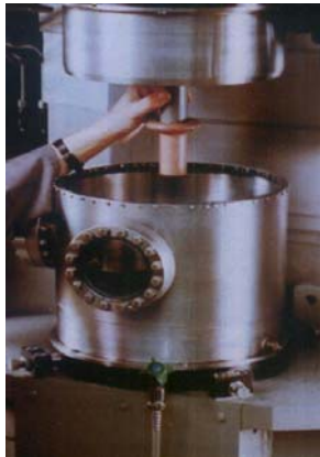
Rys. 4.78. Widok zgrzewarki tarciovej (układ pionowy) stosowanej w badaniach, z zamontowanym zbiornikiem na ciecz (a), widok stanowiska z próbkami zgrzanyimi tarciove w szczękach wrzeciona (b)
