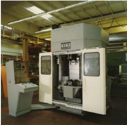
Rys. 7.12. Widok stanowiska do zgrzewania tarcowego (w układzie pionowym) (a) oraz układ sterowania i kontroli przebiegu procesu zgrzewania dla tej zgrzewarki (b)
