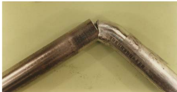
Rys. 4.28. Widok złączy zgrzewanych tarcowo stop aluminium AlMgSi 0,5 –stal austenityczna X10CrNiTi189 po statycznej próbie rozciągania (a) i po technologicznej próbie zginania (b)
