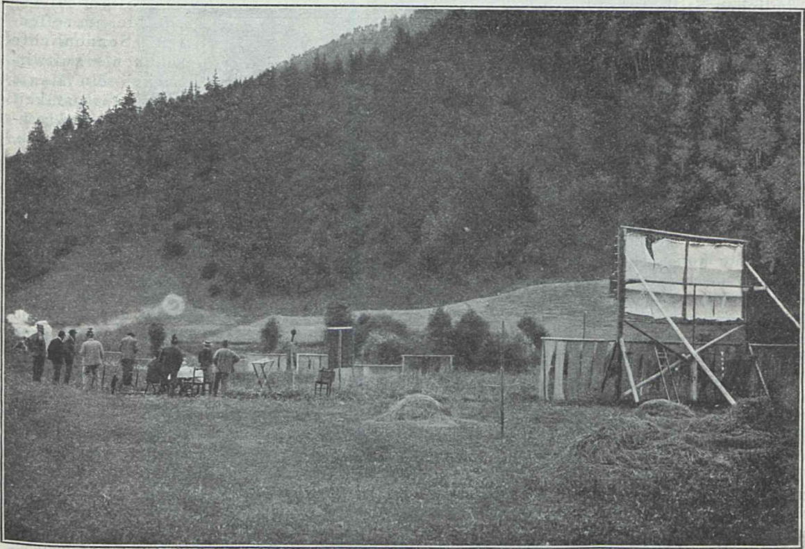
Wetterschiess-Versuche auf dem Schiessplatz des Hammerwerks Carl Greinitz Neffen in St. Katharein a. d. Lamming: Horizontalschuss und horizontaler Luftwirbelring.
