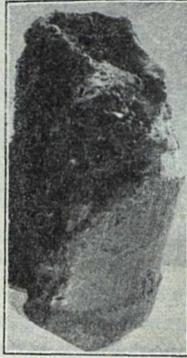
Eine ohne künstlichen Zug im Cupolofen geschmolzene Massel mit abgehobelter Gusrinde.
