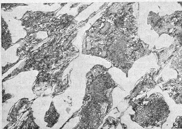
Rys. 1. Struktura odlewu surowego (białe żeliwo) — perlit, cementyt, pow. x 500.
