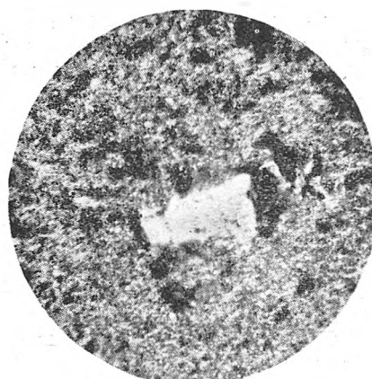
Rys. 13. Próbką miedzianą po 200 godz. przy 125°C w syciwie krajowym wilgotnym
