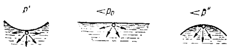
Rys. 6. Prężność pary nasyconej i siły działające na cząsteczkę znajdującą się na wklęsłej, płaskiej i wypukłej powierzchni cieczy
