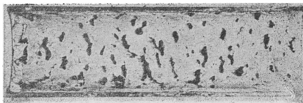
Rys. 1. Korozja lokalna rury miedzianej
