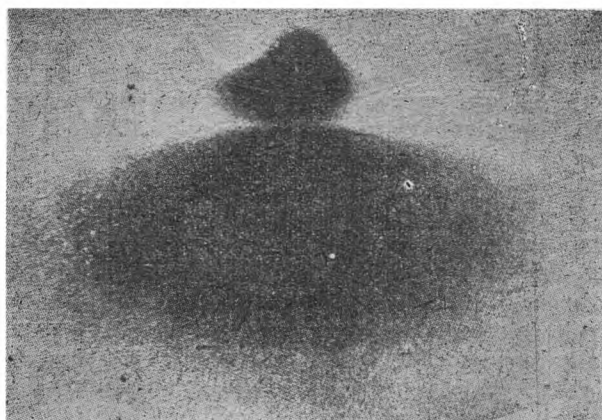
Rys. 9. Rozlane widmo odbitej wiązki elektronów od polerowanej powierzchni niklu
