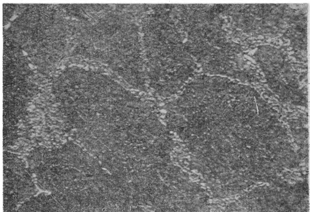
Rys. 7. Mikrobudowa stali szybko tnącej SW 18 kutej, \varnothing 130 mm, hartowanej i trzykrotnie odpuszczonej. Pow. \times 250 . Traw. kw. azotowym
