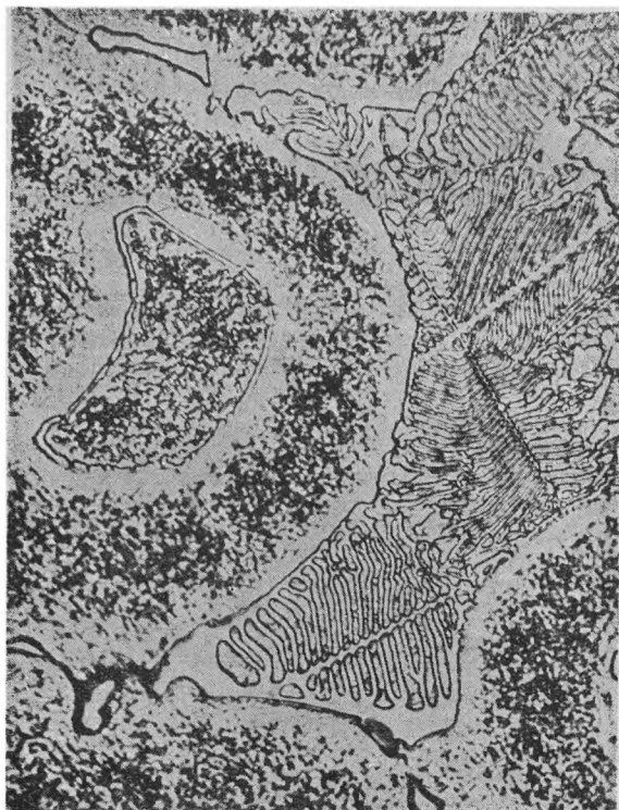
Rys. 2. Struktura surowego wlewka średnicy 150 mm ze stali 18-4-1, pow. \times 1200
