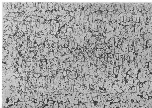
Rys. 5. Struktura próbki ze stali 18-4-1 średnicy 10 mm odlanej w formę metalową pow. \times 380
