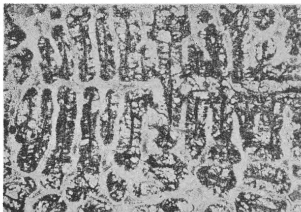
Rys. 4. Struktura próbki stali 18-4-1 średnicy 10 mm odlanej w suchą formę piaskową
