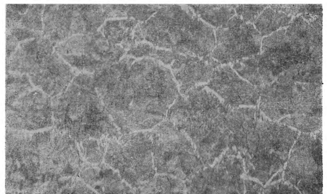
Rys. 13. Mikrostruktura części niehartowanej (ścianka i stopka) szyny z wytopu 2
