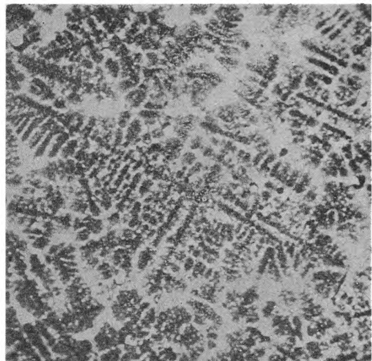
Rys. 6. Mikroradiogram stopu 80% Cu, 10% Sn, 10% Pb, promieniowanie K\alpha Co , pow. 80 \times
