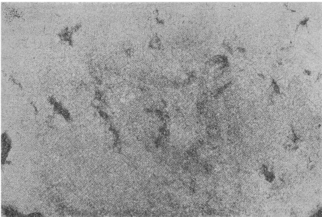
Rys. 4. Mikroradiogram odlewu glinowego z widocznymi mikroporami pow. 50 \times
