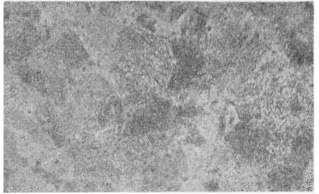
Rys. 10. Mikrostruktura główki szyny z wytopu 2 (0,45 % C), na głębokości 3 mm od powierzchni
