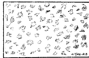
Rys. 13. Skrobanie upiększające t. zw. „mrozek”.
