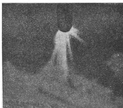
Rys. 11. Płomień palnika zanieczyszczonego odpryskami metalu.
