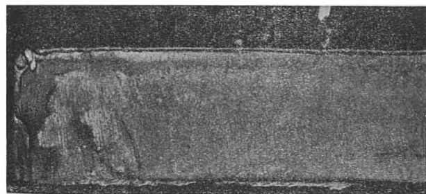
Rys. 9. Obraz przecięcia przy zbyt silnym podgrzewaniu i zbyt słabym ciśnieniu tlenu.
