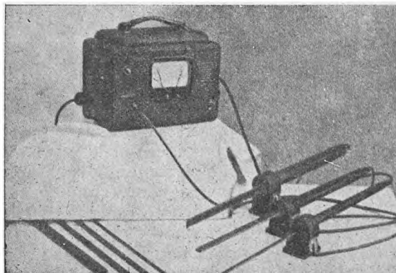
Rys. 17. Przyrząd jak na rys. 16 w zastosowaniu do mierzenia grubości ścianek rurek manometrycznych.
