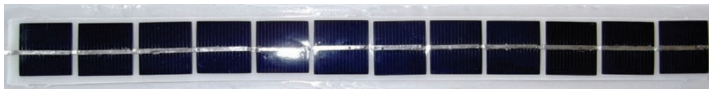
Rys. 12. Półelastyczna taśma fotowoltaiczna po procesie laminacji w układzie konwencjonalnym [96] Fig. 12. Semi-flexible photovoltaic tape in a conventional arrangement obtained by the lamination process [96]
