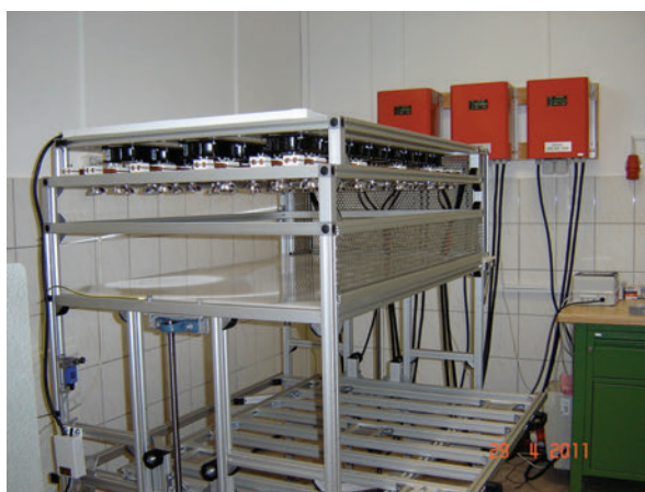
Rys. 15. Symulator promieniowania słonecznego – SOLARBOX w WITI
