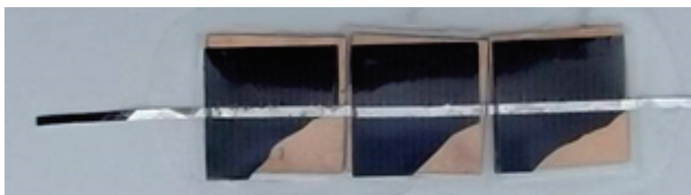
Rys. 14. Półelastyczna taśma fotowoltaiczna po procesie laminacji w układzie z dodatkowymi podkładkami pod ogniwa [96]
