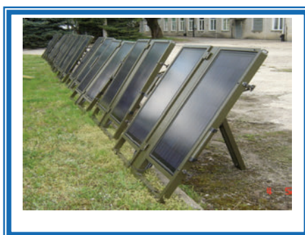
Rys. 24. Widok wybranych elementów polowej elektrowni fotowoltaicznej Fig. 24. Mobile photovoltaic power plant, view of selected items
