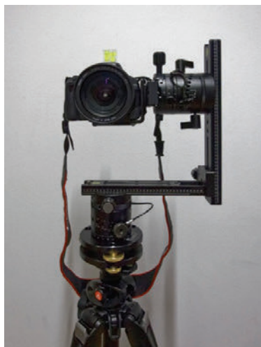
Rys. 11. Fotometr zamocowany na głowicy panoramicznej Fig. 11. ILMD mounted on the panoramic head
