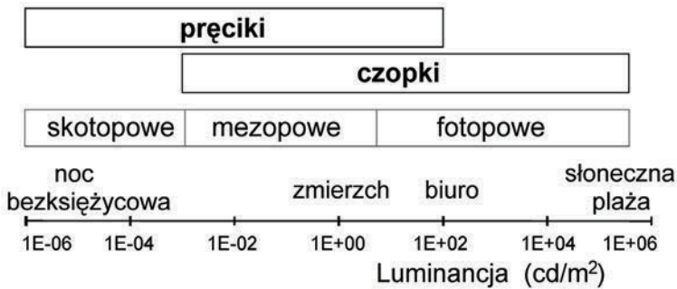
Rys. 2. Zakres dynamiczny luminancji postrzeganych przez system wzrokowy Fig. 2. Dynamic range of luminance perceived by human visual system
