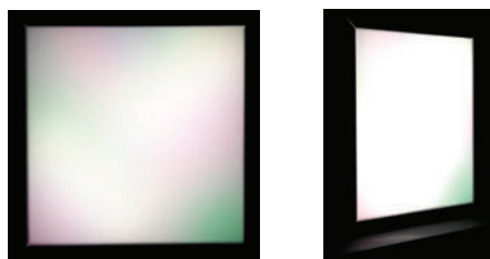
Rys. 22. Widok włączonej lampy dla ustawionej temperatury barwowej 3500 K: a) z kierunku normalnego, b) pod kątem 30°
