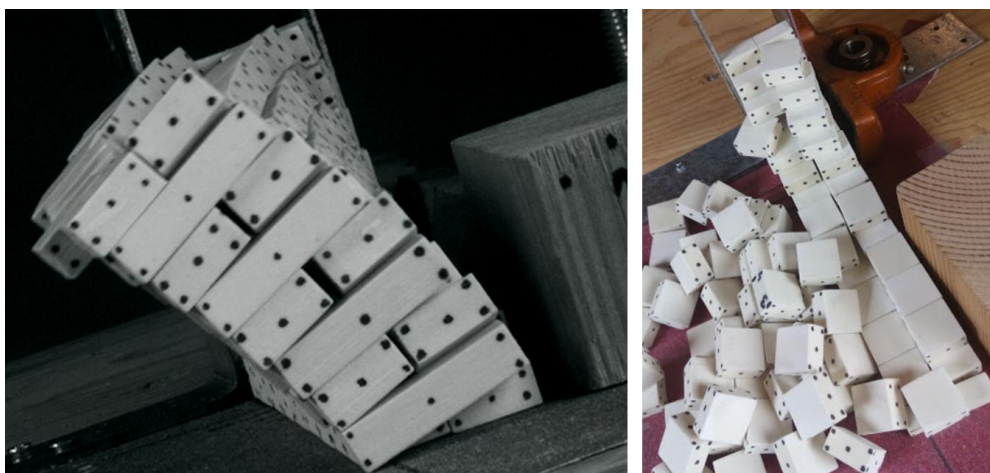
Rys. 4.71 Model 30 – mechanizm zniszczenia oraz stan końcowy
