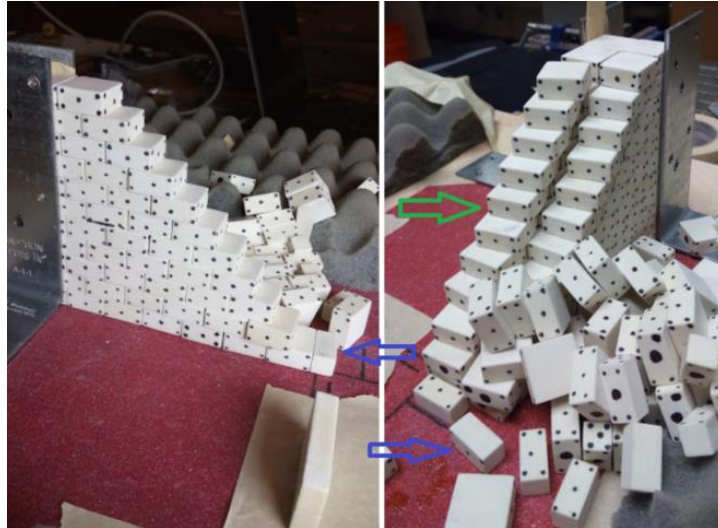
Rys. 5.121 Impuls C, próbki po obaleniu. Po lewej – model 7, po prawej model 8.
