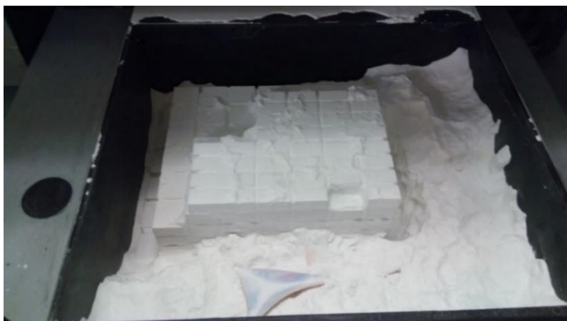
Rys. 3.8 Wydrukowane bloczki w czasie ekskawacji
