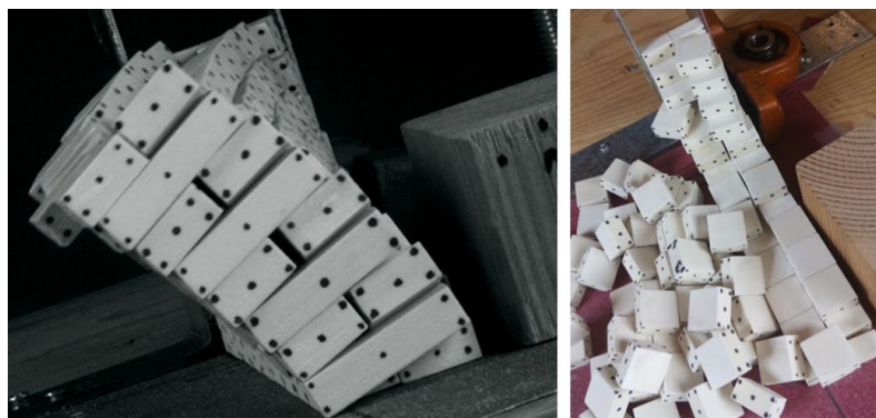
Rys. 4.79 Mechanizm zniszczenia typu ‘trapez’ oraz stan końcowy
