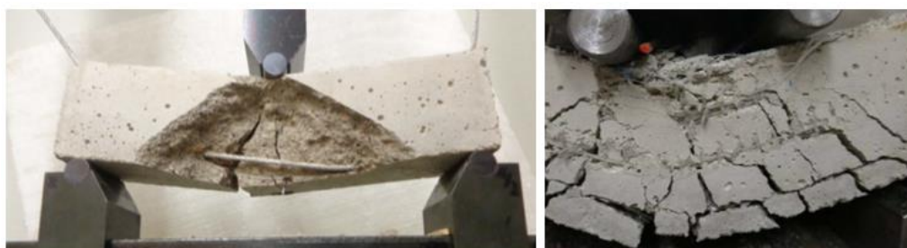
Rys. 2.48 Próba zginania wzmocnionej zaprawy – wzmocnienie cięgnami (po lewej), wzmocnienie włóknami (po prawej), [212]
