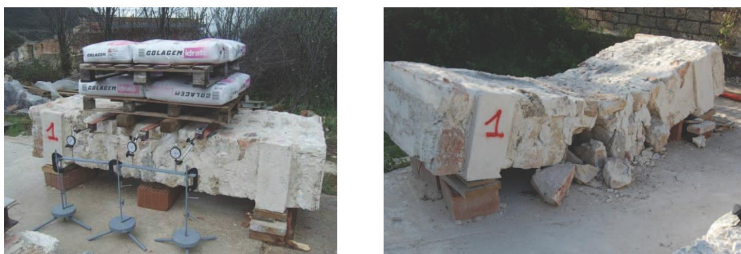
Rys. 2.47 Próba zginania czteropunktowego muru wielowarstwowego – stanowisko badawcze (po lewej), zniszczony świadek (po prawej), [211]
