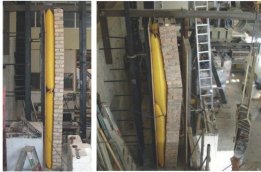
Rys. 2.10 Stanowisko badawcze murów jednokierunkowych.
