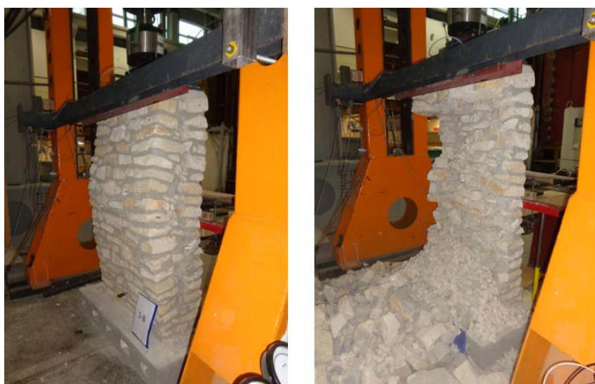
Rys. 7.1 Utrata równowagi i destrukcja warstwy zewnętrznej muru wielowarstwowego w próbie ściskania, [253]
