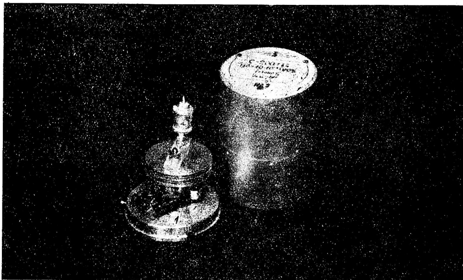
Rys. 4. Wzorzec pojemności dla tangensa kąta strat \operatorname{tg} \delta < 10 \cdot 10^{-4} . 1 — kondensator wyrównawczy, 2 — osłona, 3 — kondensator właściwy, 4 — oporniki.
