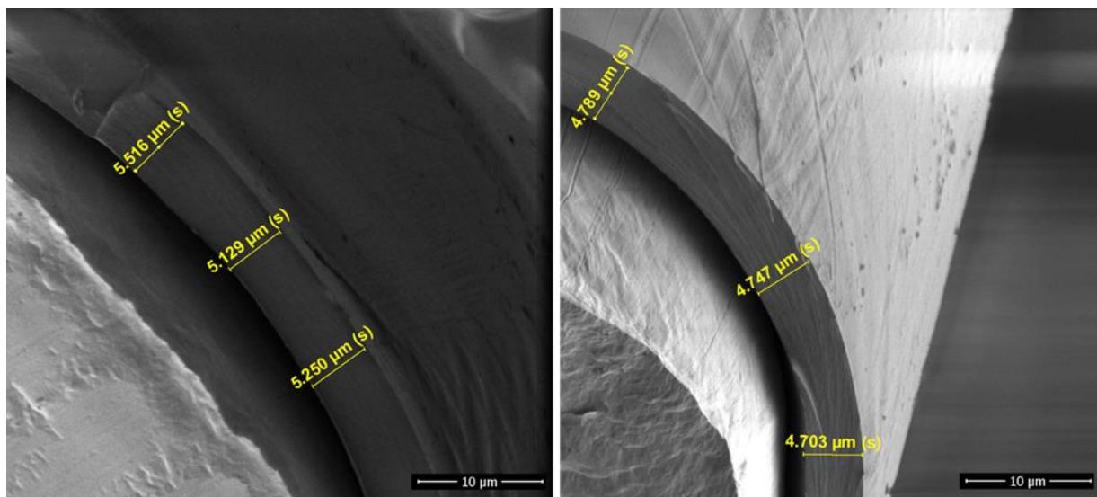
Rys. 45. Obrazy SEM komercyjnego drutu powlekanego poliuretanem wraz z pomiarami grubości powłoki.
