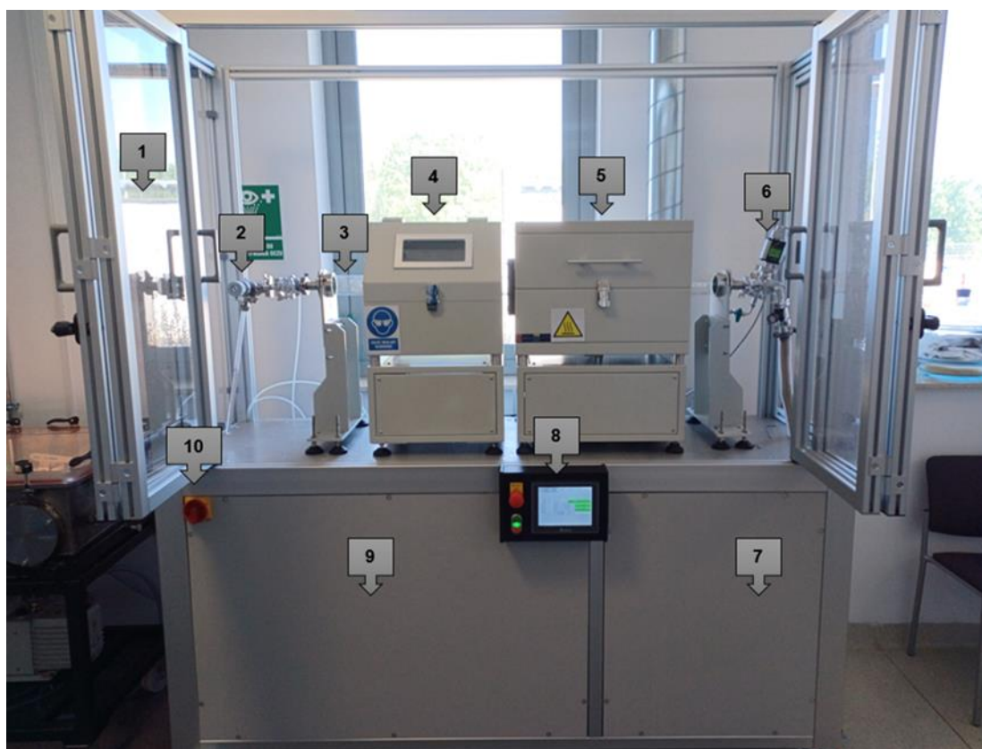
Rys. 23. Wdrożony system do okresowej syntezy grafenu: 1 – obudowa stanowiska, 2 – zawór dozujący ciekłe węglowodory, 3 – rura kwarcowa (komora reakcyjna), 4 – moduł impedancji i antena RF, 5 – piec rurowy (strefa grzejna), 6 – czujnik próżni, 7 – pompa próżniowa (zabudowana w dźwiękoszczelnej obudowie), 8 – panel operatorski, 9 – generator plazmy RF oraz układ podawania gazów zabudowany w obudowie, 10 – włącznik główny.
