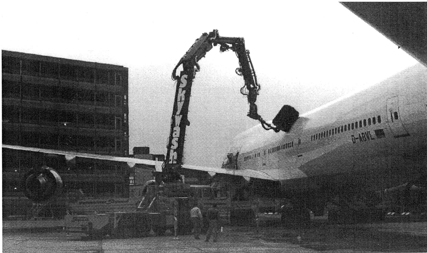
Rys. 2.12. Skywash - robot olbrzym służący do mycia samolotów (źródło: firma AEG)
