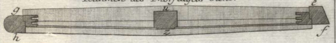
Grundriß des untersten Riegelholzes des Drehthors, wie es im Rahmen des Thorflügels steht.
