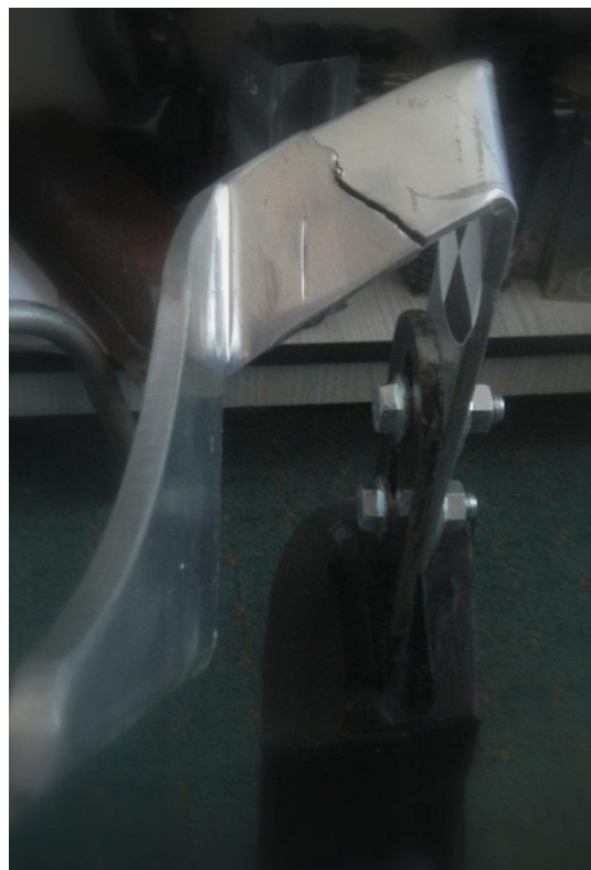
Rys. 13.10. Pęknięcia na mocowaniach PUZ_N1
