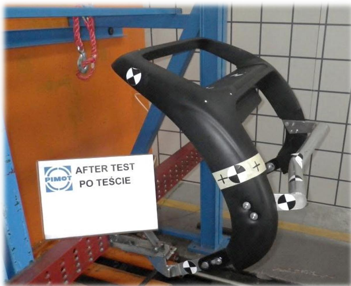
Rys. 13.8. PUZ_N1 po eksperymencie badawczym – widoczna odkształcona plastycznie poprzeczka podcinająca
