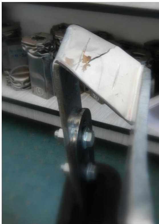
Rys. 13.10. Pęknięcia na mocowaniach PUZ_N1
