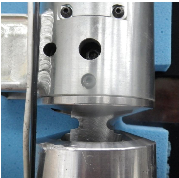
Rys. 13.11. Płaskowniki odwzorowujące więzadła stawu kolanowego po eksperymencie: a) zamontowane w impaktorze nogi; b) zdemontowane z impaktora
