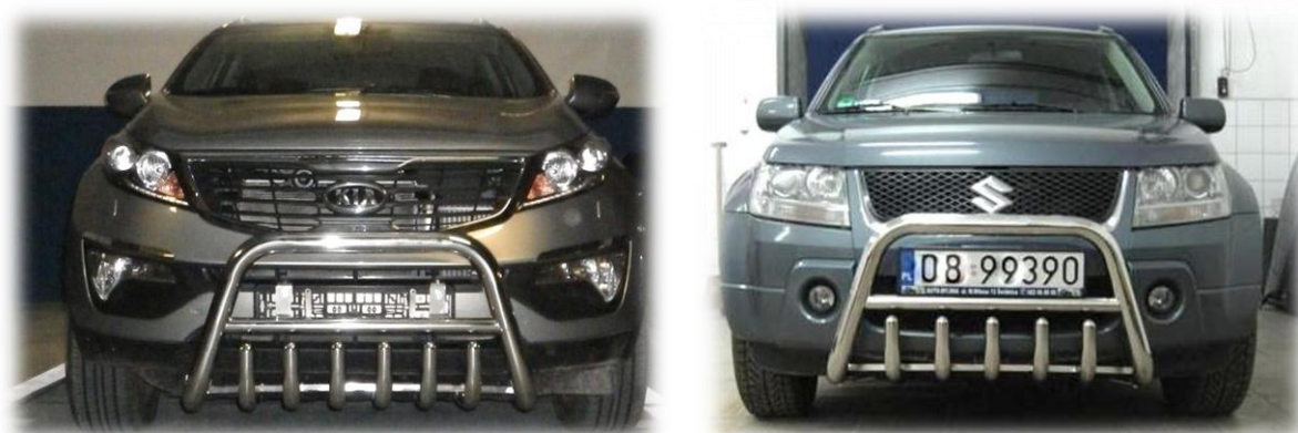
Rys. 2.7. Przedni układ zabezpieczający z giętych stalowych rur, zamontowany na pojazdach typu SUV
