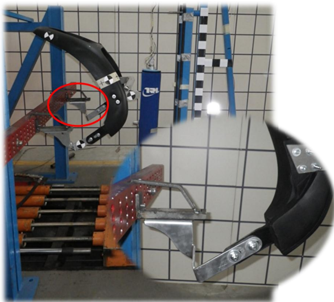
Rys. 13.9. PUZ_N1 po eksperymencie badawczym – widoczne uplastycznienie mocowania (w powiększeniu)
