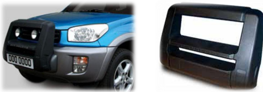
Rys. 2.8. Przedni układ zabezpieczający z tworzywa sztucznego [30]
