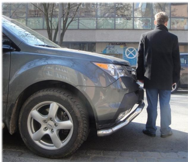
Rys. 2.3. Pojazdy typu SUV w odniesieniu do pieszych o wzroście: a) 1,70 m; b) 1,80 m
