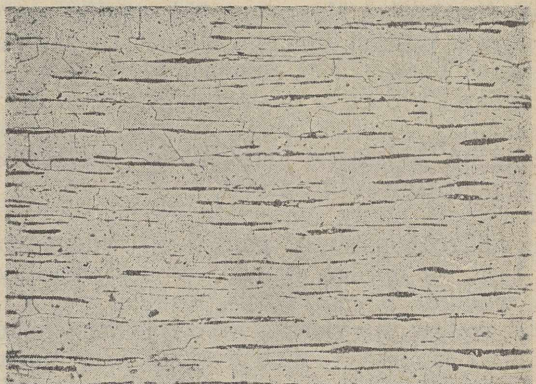
Rys. 18. Struktura platyny. Ferryt. Liczne pasma perlitu. Traw. 4 % \text{HNO}_3 . Pow. \times 50
