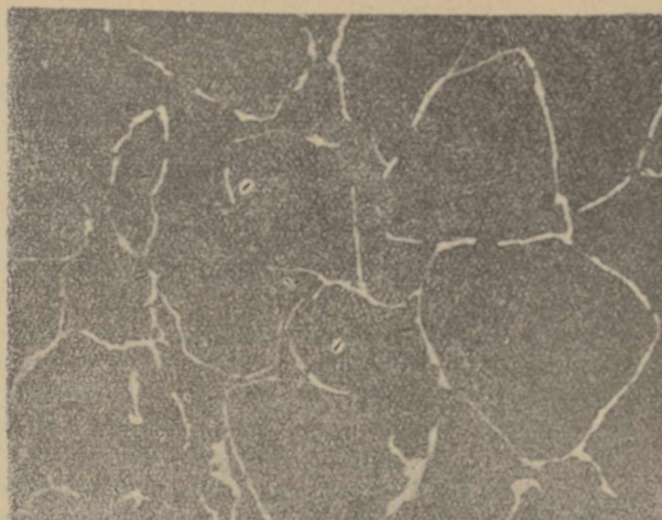
Rys. 7. Mikrostruktura spieku z proszku krzemionkowego pokrytego molibdenem, prasowanego na gorąco
