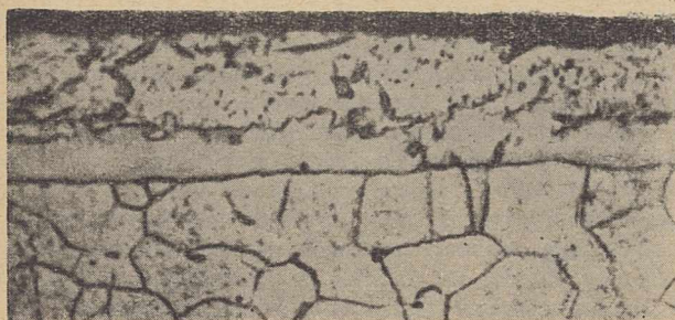
Rys. 3. Aluminiowa powłoka ogniowa na żelazie „Armco“, o wysokiej odporności na zginanie. Pow. \times 1000
