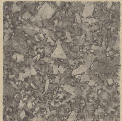
Rys. 7. Próba 16: nieznormalizowany gatunek tytanowy, struktura \times 1400 , trawiony cieplnie
