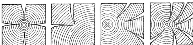
Rys. 2. Pęknięcia krawędziaków przy szybkim suszeniu
