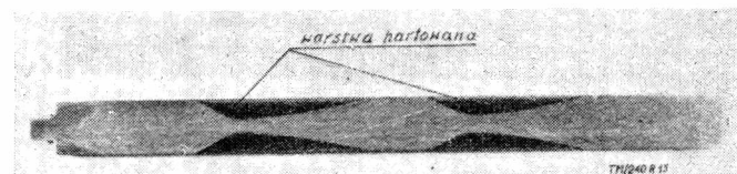
Rys. 15. Przekrój wałka pompy olejowej. Częstotliwość f = 220000 (Hz). Szybkość przesuwu 0,3 — 0,6 (cm/sek). Twardość HRC = 57 - 59 . Za małą szybkość przesuwu, rozkład i grubość warstwy hartowanej nie odpowiadają warunkom technicznym.
