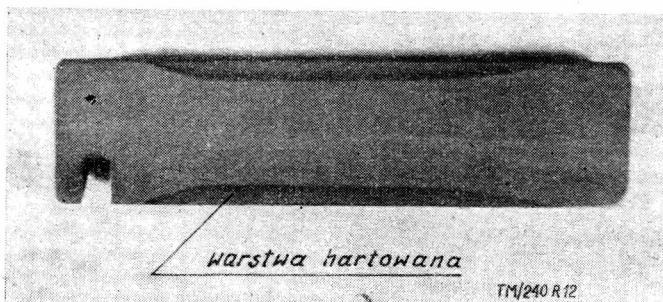
Rys. 12. Przekrój wałka koła zębatego wstecznego biegu. Rozkład warstwy i głębokość hartowania. Trawiono odczynnikami Heina.
