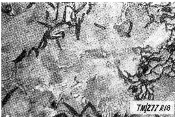
Rys. 18. Struktura żeliwa C. I. 1 w stanie surowym. Na tle jasno-szarego perlitu widać czarny grafit
