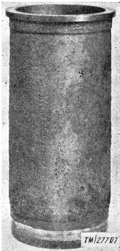
Rys. 7. Wżery powstałe wskutek niedostatecznego odstępu między tulejami
