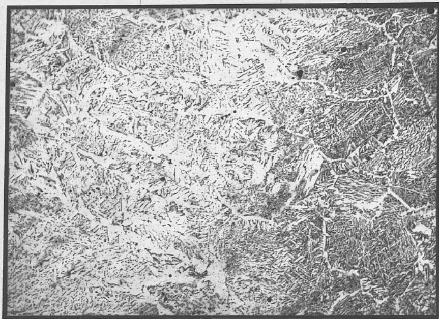
Rys.79 Mikrostruktura złącz spawanych ze stali 18G2AV /Sp1GS/ Traw. nital. Pow. 250x
