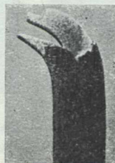
Ryc. 10. nat. wielk. Złomy widelkowe drutu profilowego poddanego próbie zginania.
