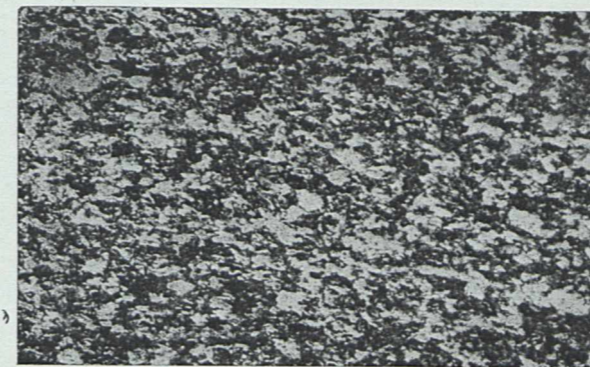
kw. azot. Ryc. 37. pow.=100 Struktura przeciętna po patentowaniu i pierwszym ciągu. Troostyt. Przekrój podłużny.
