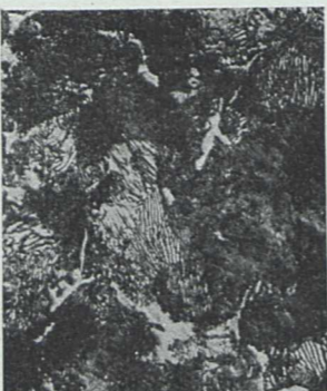
kw. azot. Ryc. 26. pow.=500 Przekrój poprzeczny.
