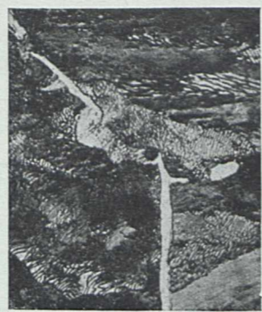
kw. azot. Ryc. 23. pow.=500 Przekrój poprzeczny.
