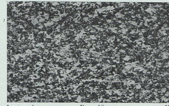
kw. azot. Ryc. 40. pow.=100 Struktura przeciętna po patentowaniu i drugim ciągu. Troostyt. Przekrój podłużny.
