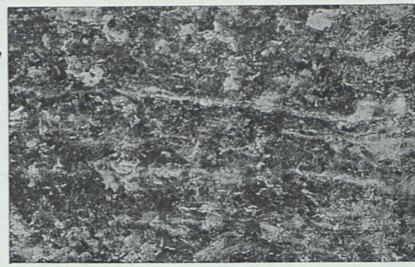
kw. azot. Ryc. 34. pow.=100 Struktura przeciętna po drugim normalizowaniu i walcowaniu. Przekrój podłużny.
