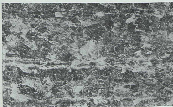
kw. azot. Ryc. 28. pow.=100 Struktura przeciętna po pierwszym ciągu. Perlit z wysepkami ferrytu. Przekrój podłużny.
