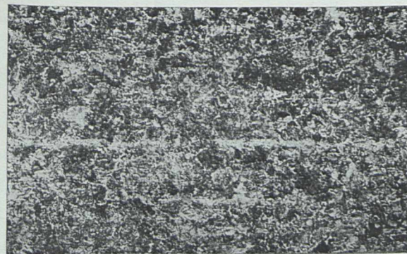
kw. azot. Ryc. 25. pow.=100 Struktura przeciętna walcówki. Perlit z wysepkami ferrytu. Przekrój podłużny.
