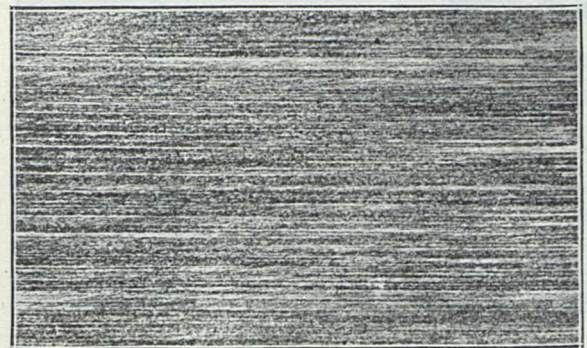
Oberhoffer. Ryc. 8. pow. = 5 Struktura pierwotna, jednokierunkowa — widoczna. Stal A.
