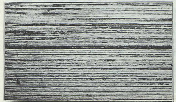
Oberhoffer. Ryc. 9. pow. = 5 Struktura pierwotna, jednokierunkowa — wyraźna. Stal B.
