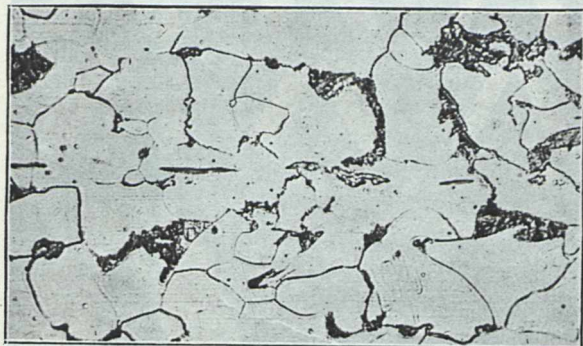
Kw. azot. Ryc. 13. pow. = 500 Struktura drobnoziarnista. Ferryt i perlit na grani- cach ziarn przy miejscowym, pasemkowym ugrupo- waniu. Stal A.
