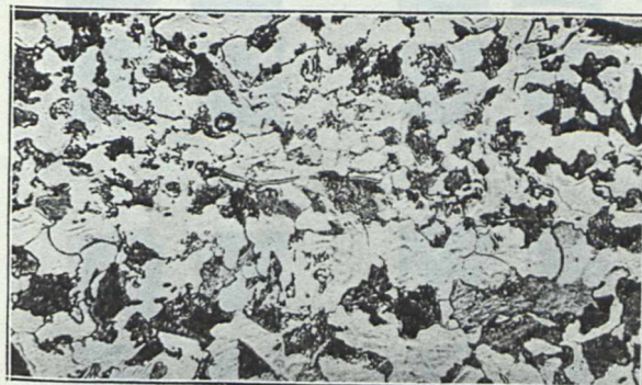
Kw. azot. Ryc. 15. pow. = 500 Struktura drobnoziarnista. Ferryt z perlitem tworzy miejscowe, pasemkowe ugrupowanie. Stal B.
