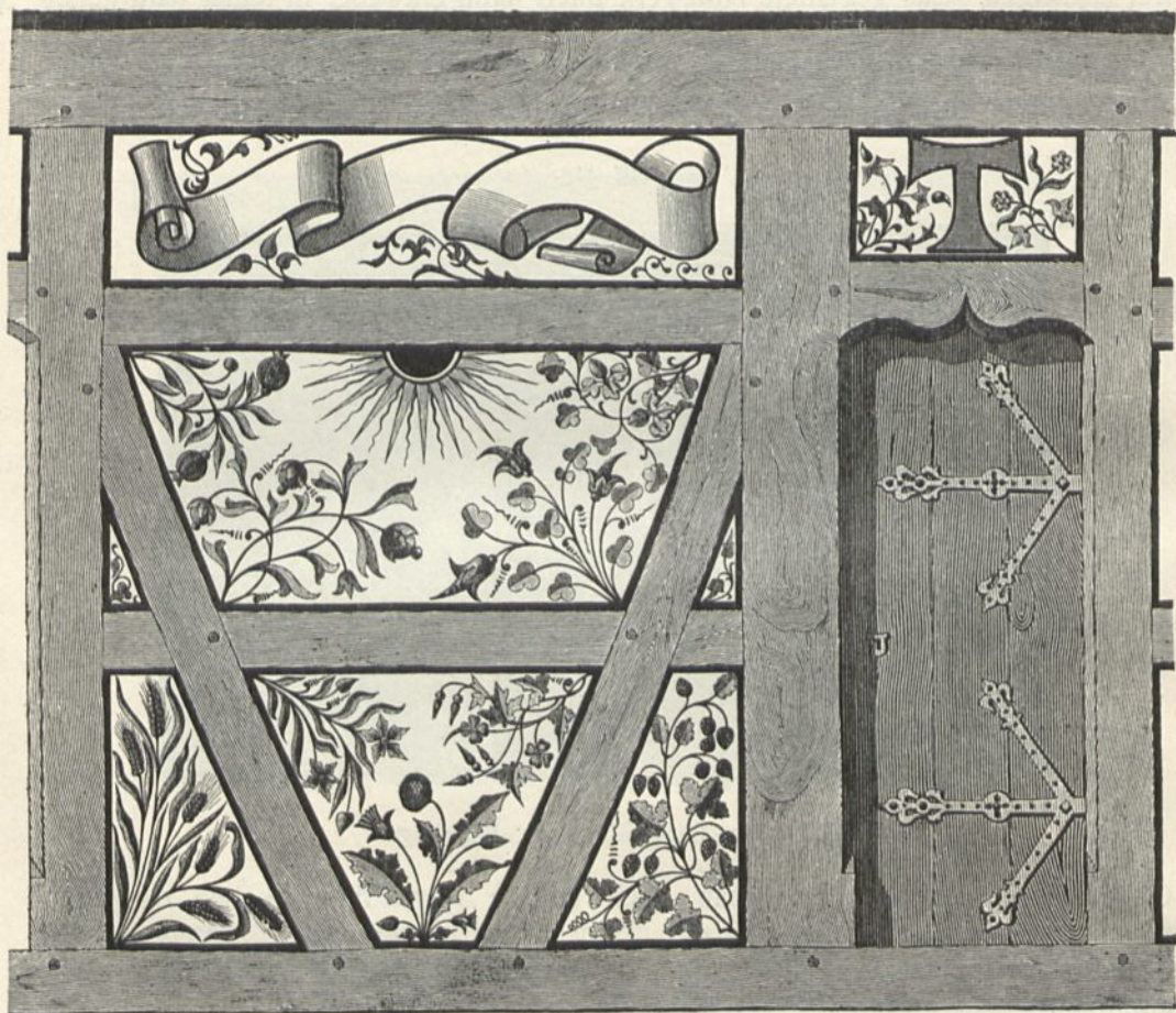
Fachwerkwand im Kloster zu Bebenhausen 307) .
