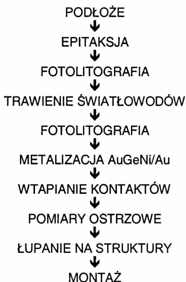
Rys. 5.6. Schemat procesu technologicznego wytwarzania modulatora elektrooptycznego w heterostrukturze GaAs/AlGaAs
