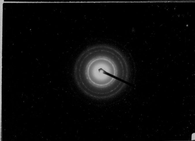
Rys. 3.35. Obrazy dyfrakcyjne preparatu złota otrzymane na mikroskopie elektronowym JEM-100B dla różnych wartości średnicy przesłony selekcyjnej przy U = 100 kV.
