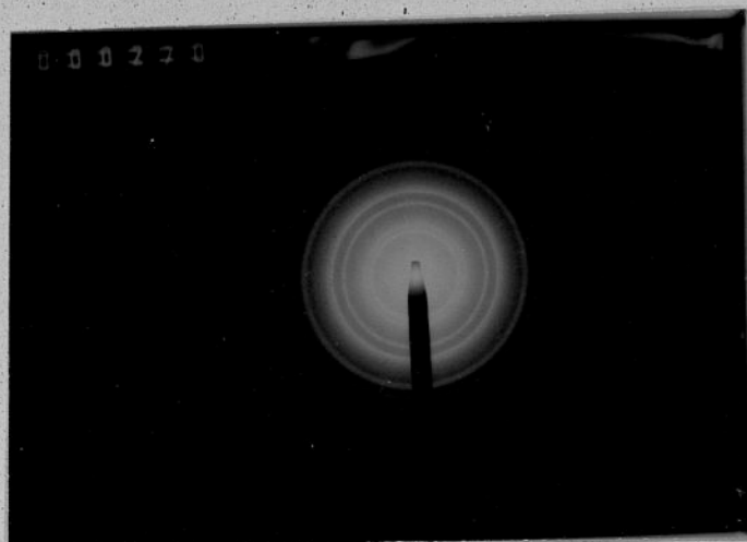
Rys. 3.43. Obrazy dyfrakcyjne preparatu złota otrzymane na mikroskopie elektronowym EM-301 dla różnych wartości średnicy przesłony selekcyjnej przy U = 100 kV.
