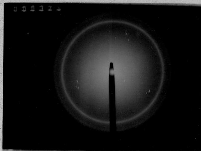
Rys. 3.44. Obrazy dyfrakcyjne preparatu złota otrzymane na mikroskopie elektronowym EM-301 dla różnych napięć przyspieszających przy \Phi = 30 \mu\text{m} .
