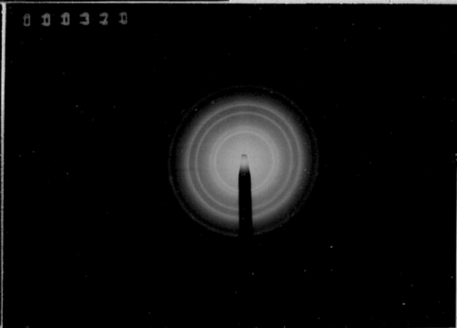
Rys. 3.42. Obrazy dyfrakcyjne preparatu złota otrzymane na mikroskopie elektronowym EM-301 dla różnych stałych dyfrakcyjnych przy U = 100 \text{ kV} i \Phi = 30 \mu\text{m} .
